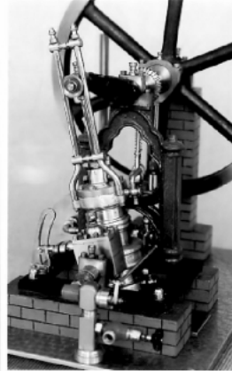
oben: Die Stellung des schwingenden Zylinders zeigt die gleichzeitig veränderte Stellung der Schieberstange, die durch die feststehende Kulissee beibehält wird.
